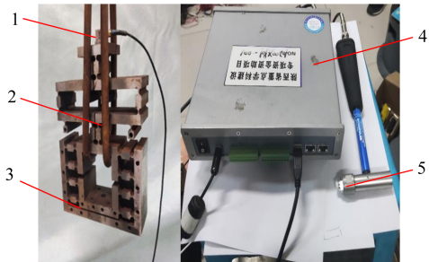
1. 数据传感器 Data sensor; 2. 橡皮绳 Rubber cord; 3. 二级缩小微动机构 Two-stage reduced micro-motion mechanism; 4. M+P 动态测试控制分析系统 M+P dynamic test control analysis system; 5. 高精度力锤 High precision force hammer。
