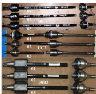
图 7 传动轴试验后破坏图
