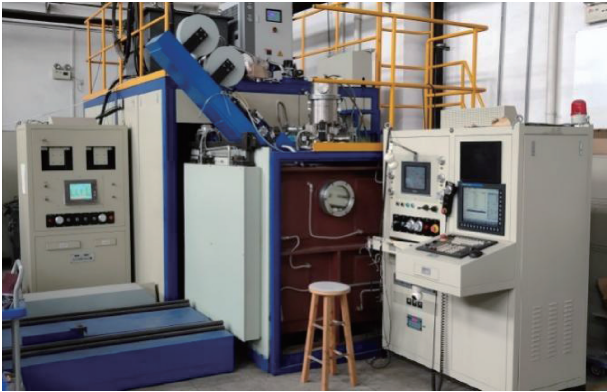
图 1 电子束熔丝沉积设备 Fig. 1 EBFD equipment
