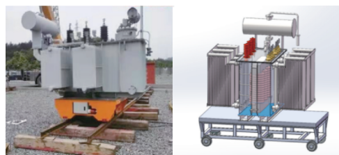
图 1 轨道运输车-变压器耦合实体模型
