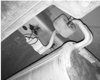
图 1 吊挂点车身侧钣金开裂故障图
