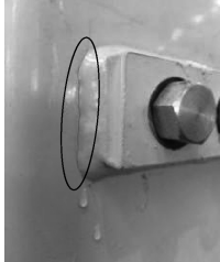
图 10 样件 1#回油座焊趾处开裂
