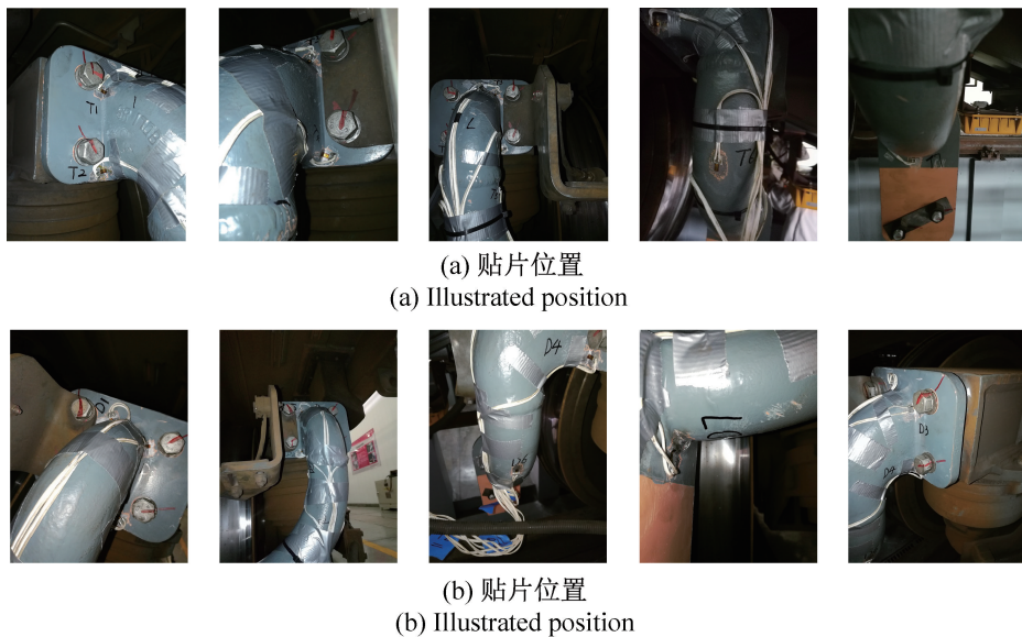
图 11 排障器测点贴片方案
