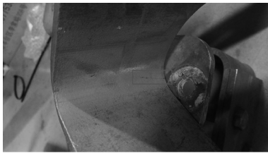
图 5 排障器裂纹萌生
