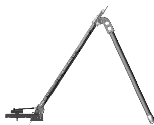
图 7 主闸刀 Adams 动力学仿真模型
