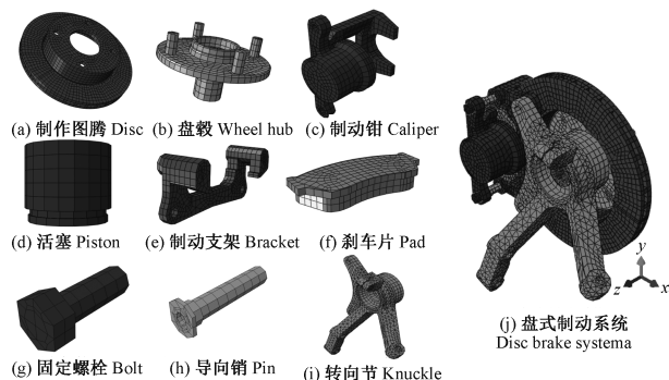
图 1 制动器有限元模型及各零部件几何模型
