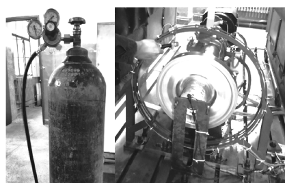
图 7 高压氮气冲击叶片现场
