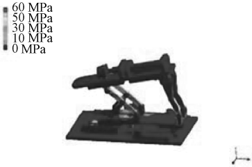
图 4 整机静力学分析 Fig. 4 Static analysis of the robot
