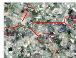
(b) 砂轮表面形貌局部放大图
