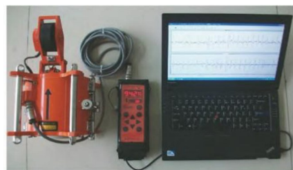
图8 钢丝绳检测系统
