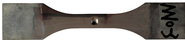
(b) 疲劳试件实物
