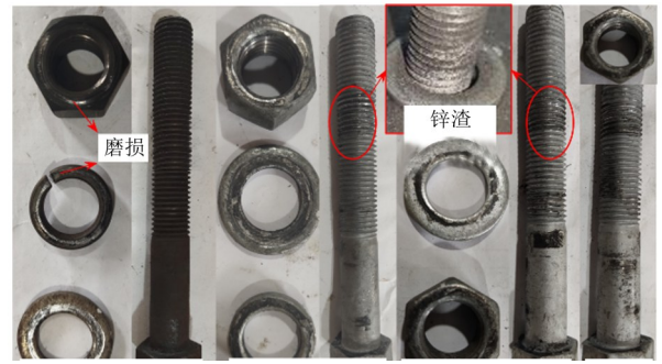
(a) 磷化弹簧垫圈 (b) 镀锌弹簧垫圈 (c) 镀锌平垫圈 (d) 无垫圈
