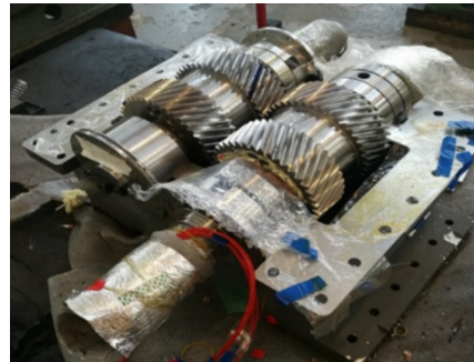
图4 人字齿轮副实物
