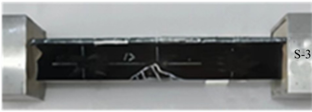
(b) 试件 S-3 界面分层破坏模式
