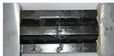
(a) 试件S-3长桁破坏模式
