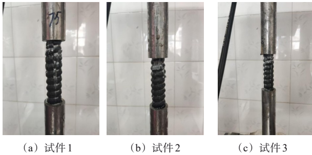
图 7 拉伸试验后玻璃钢杆体试件破坏形态
